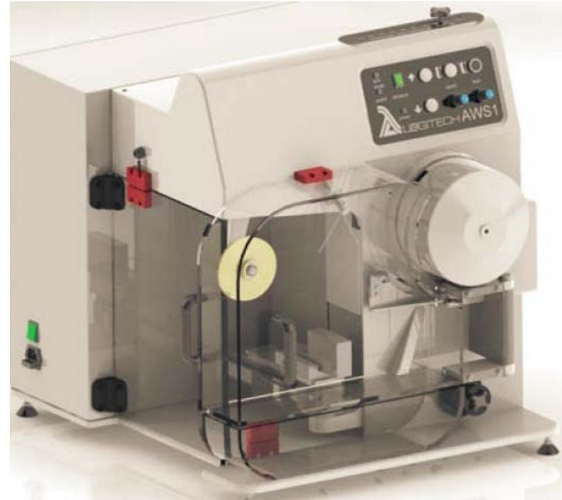
**Cutting wire: Diameter 0.25 or 0.2mm**
